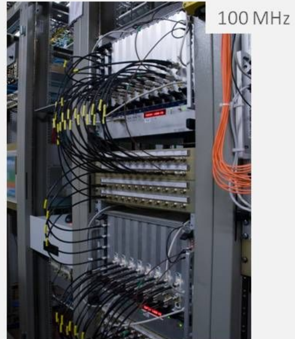
Linux cPCI & NI PXI-5122 14bit/100Ms/s digitisers
